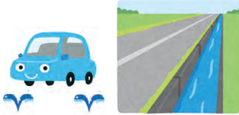
● 下水処理水の熱を利用 暖かい処理水で雪を溶かす
